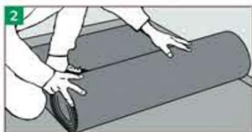
2 Auf dem verlegereifen Untergrund (bei mineralischen Untergründen Dampfbremsefolie-Diffufol - verwenden) ZIRO-Rollenkork als Trittschalldämmung einfach ausrollen und Bahnen dicht aneinander stoßen.
